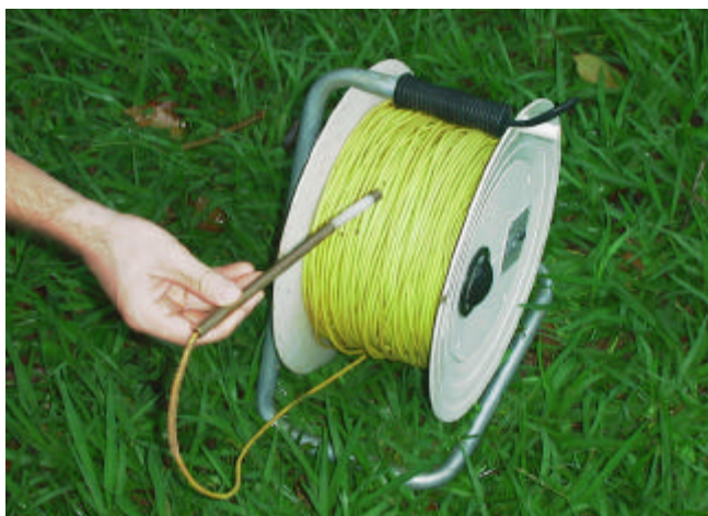
Figura 5. Sensor utilizado para medição do nível freático.
